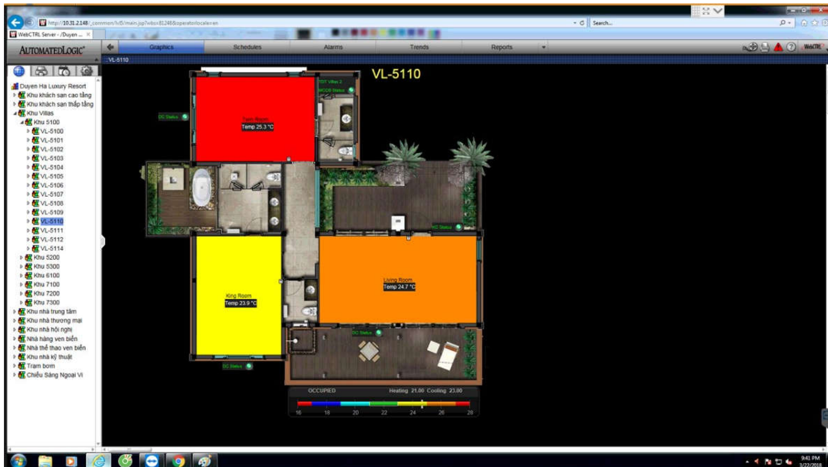
Giao diện vận hành hệ thống buồng phòng khách sạn Hotel room control and monitoring interface
